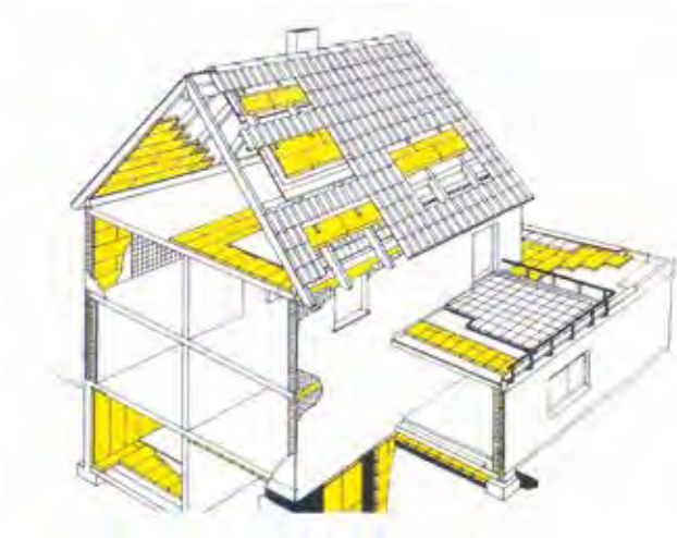
Esempi applicati dell'utilizzo del pannello in polistirene
